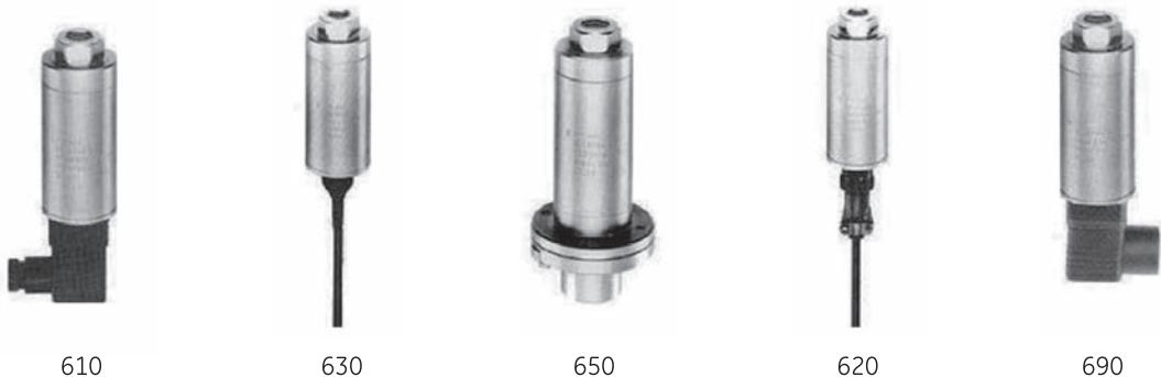
600 系列压力传感器采用先进的微加工硅压阻传感器作为核心元件，隔离膜片采用哈氏合金，壳体使用不锈钢。隔离膜片的结构保证传感器在电气和物理上与被测介质完全隔离。
